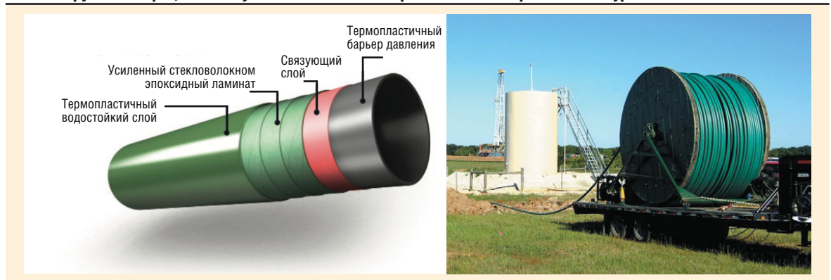
Рис. 6. Труба Fiberspar, используемая в технологии горизонтально-направленного бурения
